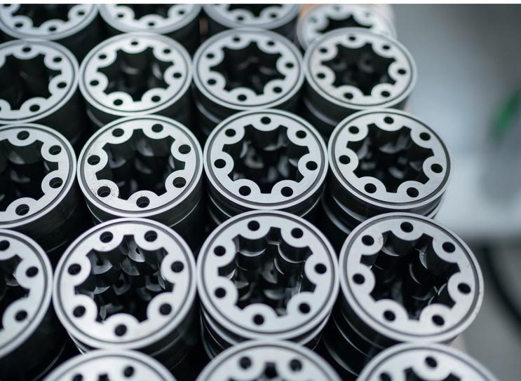
3 Mit der Planomat XT mit Vertikalspindel kann man den Aufwand vermeiden, geräumte Innenprofile mit den Rotoren zu paaren. Zugleich lässt sich die Bauteilqualität erhöhen
